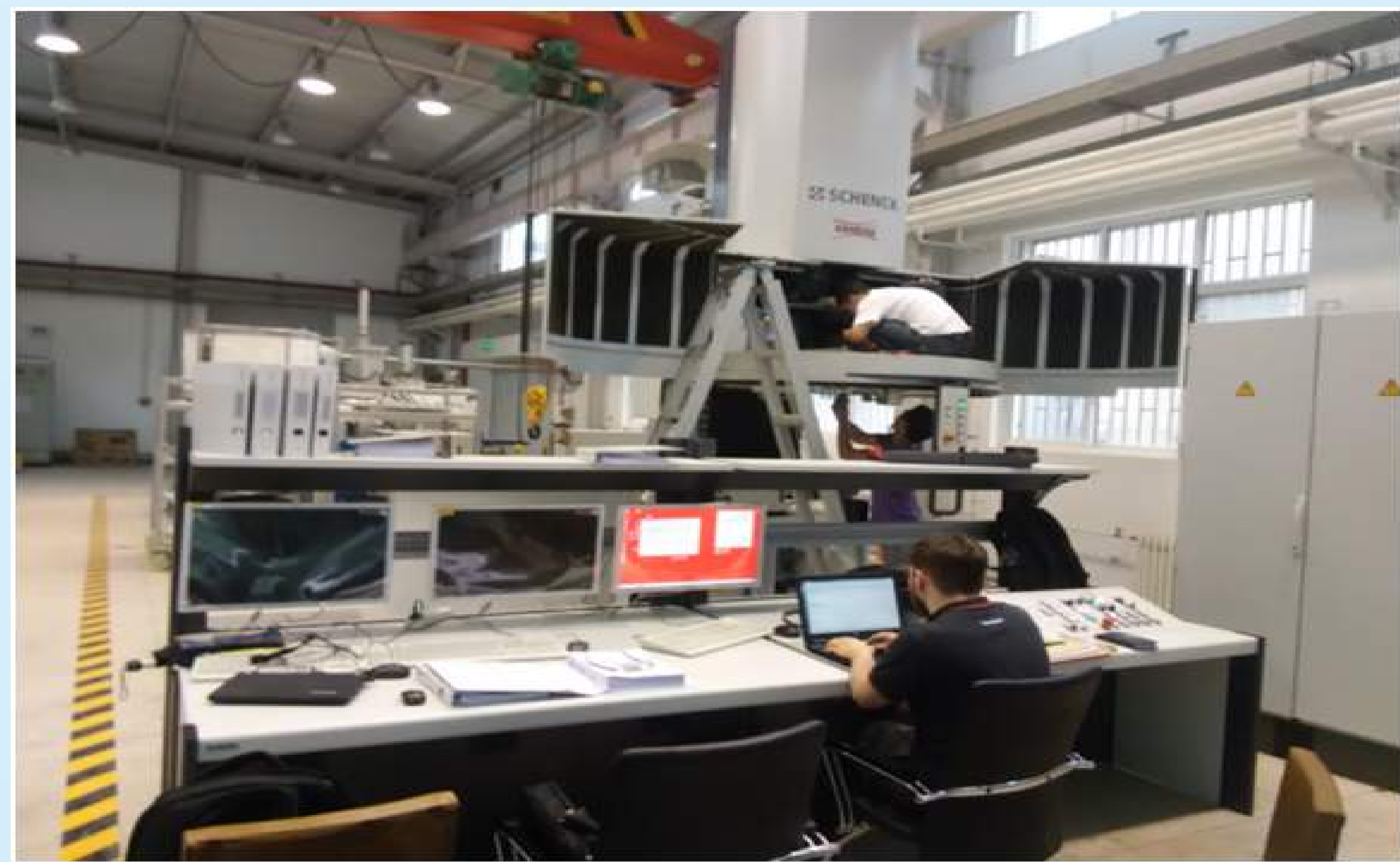
高速转子疲劳强度及极限强度测试平台
